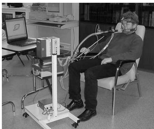
FIG. 2.4 – Photographie d'un sujet sain en assistance ventilatoire avec le pneumotachographe, le capteur de pression différentielle et la chaîne d'acquisition : le tout monté sur une table avec bras articulé.
