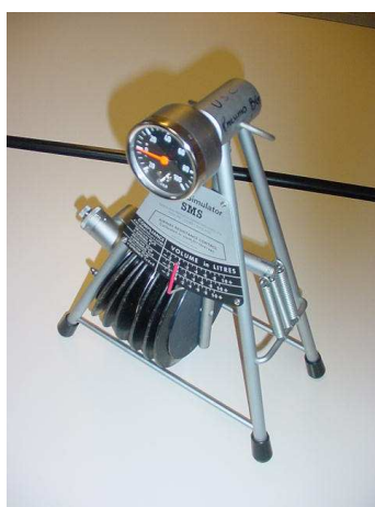
FIG. 3.1 – Le poumon mécanique utilisé est constitué d'un soufflet raccordé au support par trois ressorts, leur connection permettent de varier la compliance du poumon mécanique.
