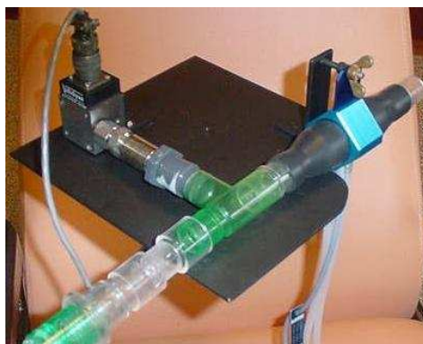
FIG. 2.7 – Photographie de la plaque comprenant le pneumotachographe, le capteur de pression différentielle et la fuite intentionnelle.
