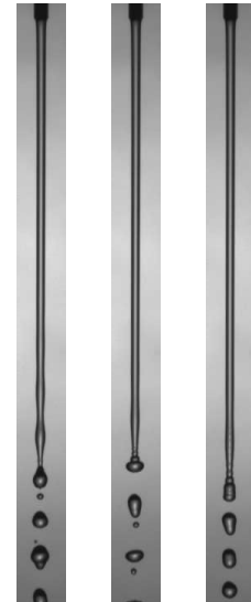
Figure 2.34: Photographies du jet libre. Son comportement est décrit par la théorie de Rayleigh.
