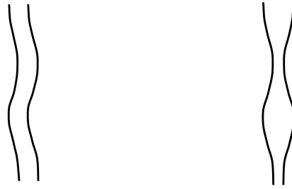
Figure 2.3: Schéma représentatif des deux types de perturbations observées sur le jet d'eau excité au moyen d'une caméra CCD: a) déplacements transverses; b) perturbations préservant la symétrie axiale du jet.
